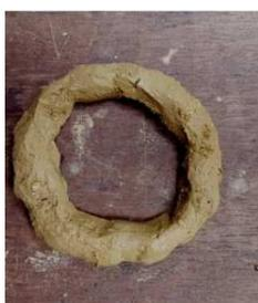
Test tactile au champ: la réalisation d'un boudin et le touché "poisseux" lorsque l'on pince alternativement la terre entre le pouce et l'index indique une teneur en argile supérieure à 40% sur cet échantillon extrait de l'horizon (B) structural d'un profil (cf. méthode des tests tactile INRA en annexe)
