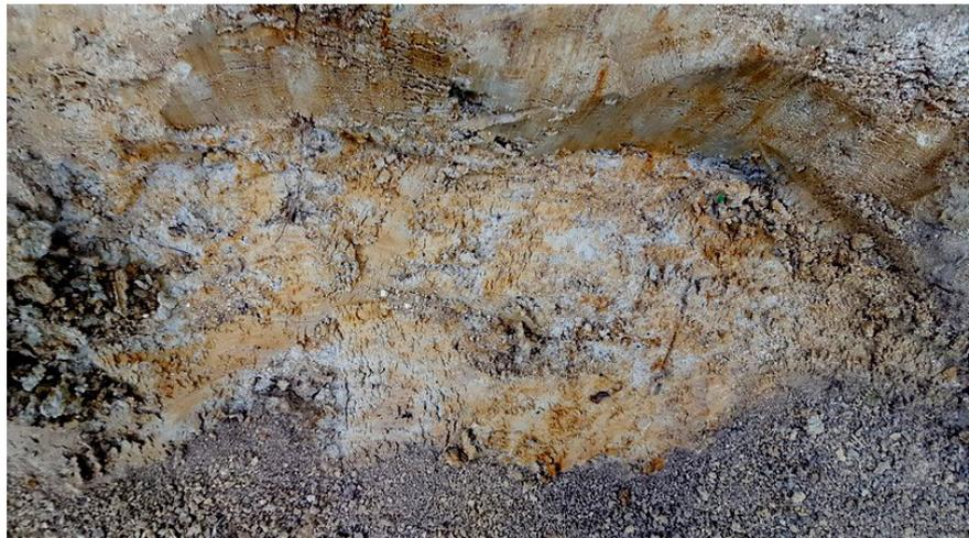
La battance de la nappe alluviale provoque des alternances de période d'anoxie où le fer se réduit (couleur gris-vert-bleu) et d'autres où il s'oxyde (couleur rouille) donnant à l'horizon cet aspect bicolore typique.
